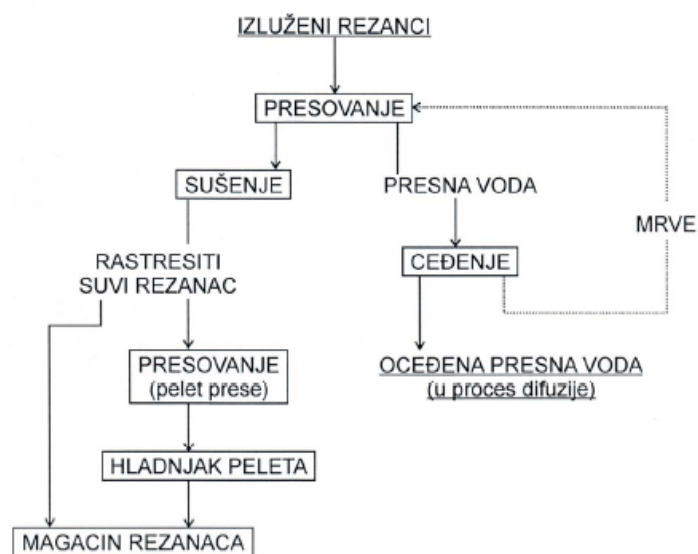
Slika 9. Blok šema tehnologije obrade izluženih rezanaca u Sušari repinih rezanaca
